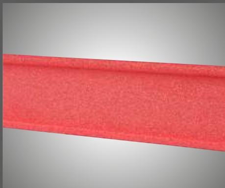
Giunto di dilatazione ECOTEK per la creazione dei giunti elastici a lunga durata in gettate per riscaldamento a norma DIN 18560 e per la delimitazione di campi di gettata. Realizzato in schiuma PE-LD a celle chiuse, dotato di adesivo nella parte inferiore, con profilo a doppia "T".
