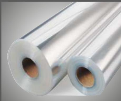
Foglio in polietilene PE-LD ECOTEK a norma UNI EN 1264-4, da posarsi a protezione dell' isolante dall' umidità del massetto durante le fasi di getto e a garanzia di assenza di ponti termici e acustici corrispondente alle richieste secondo DIN 18560. Foglio in polietilene con spessore 0,18 mm da posare con una sovrapposizione tra fogli affiancati di almeno 8 cm, da nastrarsi e sigillarsi in presenza di massetti particolarmente fluidi, autolivellante e a base anidritica.
