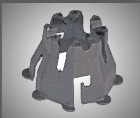
Distanziale per doppia rete in polipropilene assicura l' ancoraggio della rete elettrosaldata e garantisce la massima tenuta della struttura metallica all' interno dei getti in calcestruzzo per una maggiore resistenza alla compressione salvaguardando i requisiti richiesti dal D.M.0901/1996. Assicura il sollevamento della struttura metallica dal fondo (30 mm) e l' ottimale distanza tra le due reti (55 mm) e la tubazione, (filo rete max Ø 10 mm).
