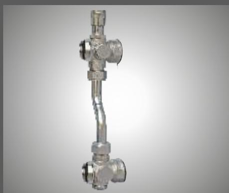
Valvola di bypass per collettori ECOTEK completa di bocchettoni Ø 1" con maschio girevole garantisce il funzionamento della pompa di circolazione come da progetto evitando lo sbilanciamento dei circuiti e fastidiosi rumori dovuti dall' aumento della velocità del fluido nell' attraversamento degli organi di regolazione.
